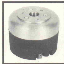
DR 11.13. Professioneller Mittelfrequenz-Treiber. Sehr ausgeglichener Frequenzgang, 70/100 W, 8 Ohm. Übertragungsbereich 800—20 000 Hz (1 000—12 000 Hz \pm 2 dB), mittl. Kennschalldruck 108 dB/1W/1m.
